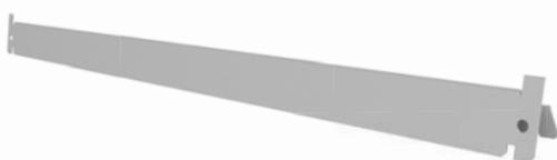
Стяжка балок выполнена из оцинкованного металлического V-образного уголка. Соединяет две балки уровня хранения. Увеличивает несущую способность яруса хранения. При больших нагрузках предотвращает балки от внешнего выворачивания (раскрытия).
