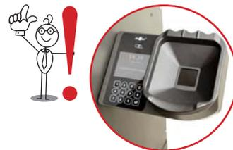
На ячейках хранения устанавливаются электромеханические замки KABA MAUER (Германия), с электронным управлением от терминала и ключом клиента.
