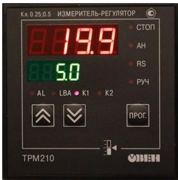
Рис. 12. Измеритель ПИД-регулятор одного термостата медицинского изделия TS-3/100
