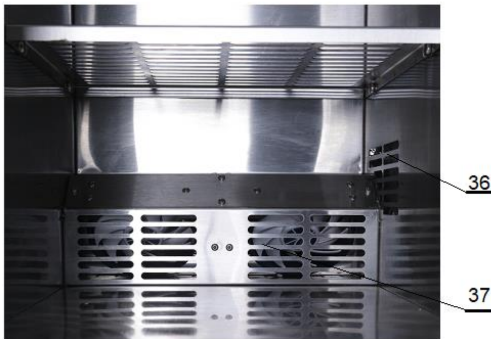
Рис. 7. Блок вентиляторов левой рабочей камеры.
