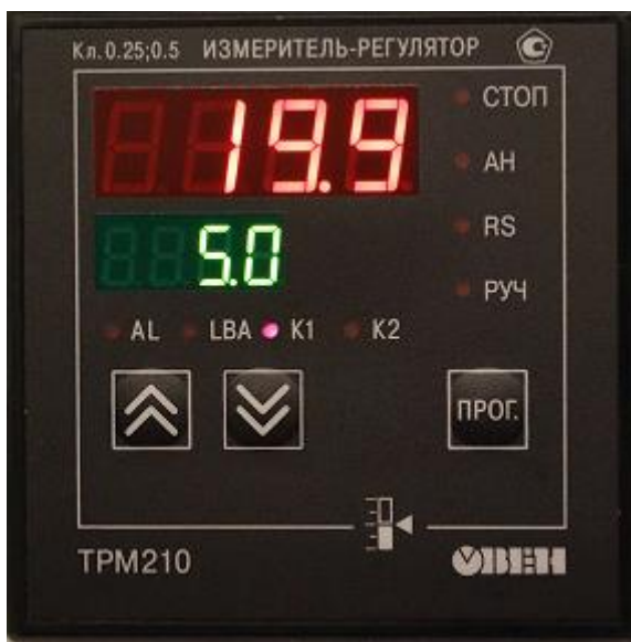
Рис. 12. Измеритель ПИД-регулятор одного термостата медицинского изделия TS-3/100
